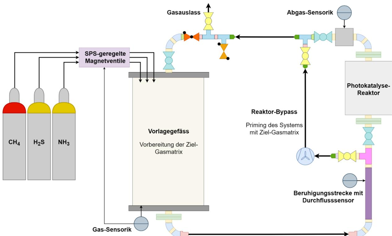
Die von der Mfpa entwickelte Prüfplattform ist in der Lage, vollautomatisiert reale Schadstoffkonzentrationen auf individuelle Reaktoren zu beaufschlagen.
