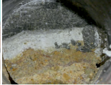
Reaktionssaum zwischen einem hydraulischen Verpressmörtel (oben) und einem Gipsmörtel
