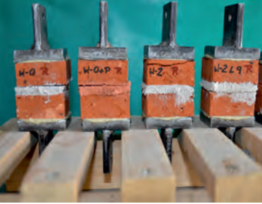
Haftzugprüfungen im Verbund Mauerziegel - Gipsmörtel
