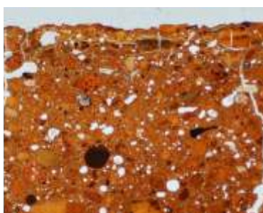
Dünnschliff eines historischen Verfügmörtels
