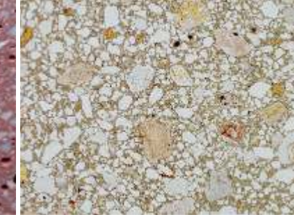
Dünnschliff eines hydraulischen Verfügmörtels
