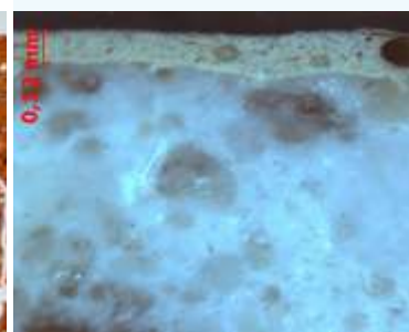
Schichtenaufbau einer Putz- und Anstrichprobe
