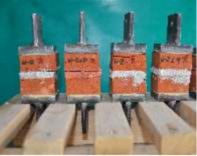
Haftzugprüfungen im Verbund Mauerziegel - Gipsmörtel
